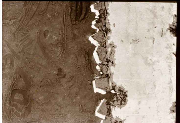
Figure 2: (Vergr. 500x) Ketelstaal, gecorrodeerd in 0.5 n NaOH bij 250° C gedurende 5 dagen; er is een Bloom-type oxydelaag gevormd, bestaande uit een enkele compacte laag van aaneengegroeide magnetietkristallen.
