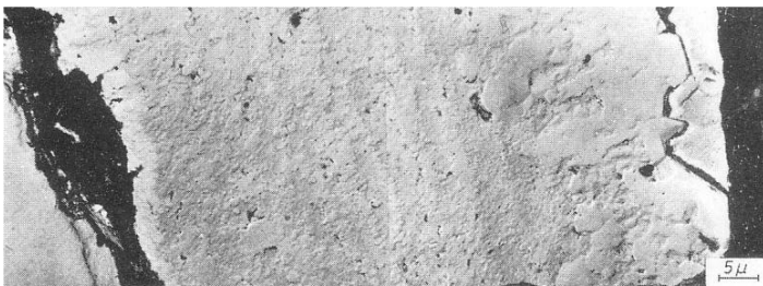
Bild 7. Elektronenmikroskopische Aufnahme (Replika-Verfahren) von lamelliertem Oxid, das durch \text{FeCl}_2 gebildet wurde. Der Abdruck ist an der korrosiven Zwischenphase zerbrochen.
