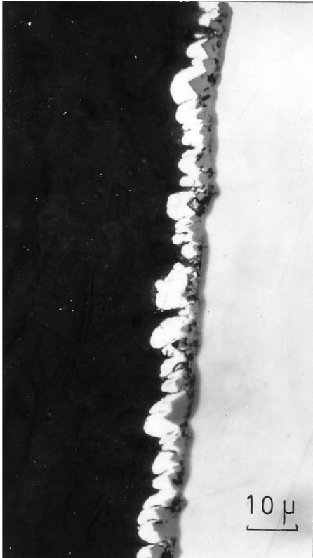
Bild 1. Stahl B (Mikroaufnahme) korrodiert in 0,5 n NaOH + 5 mg/L Chlorid
