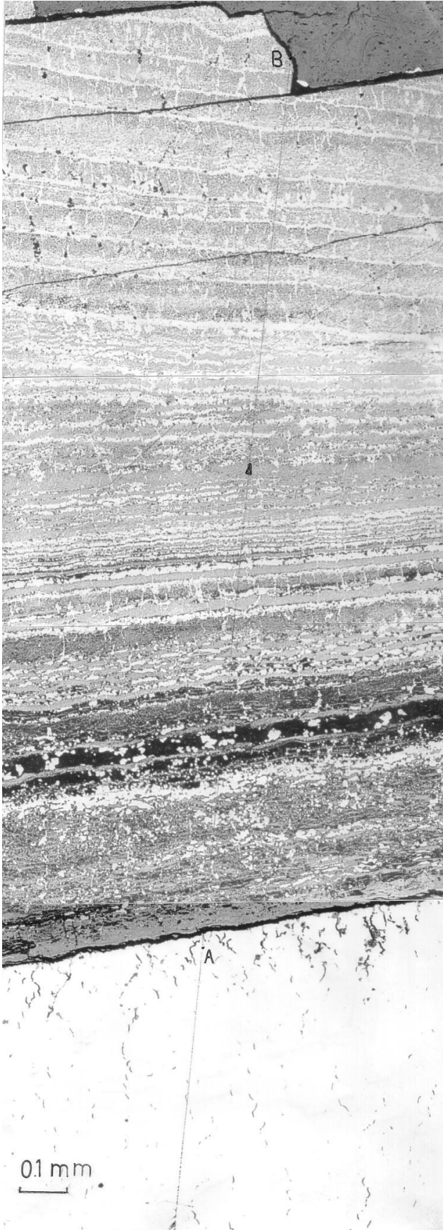
Bild 10. Dicke geschichtete Oxideschicht in einer Korrosionsgrube aus einem Kesselrohr (Mikroaufnahme).
