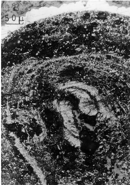
Bild 3. Chemisch reiner Eisendraht (Mikroaufnahme), korrodiert in 0.1 n NiCl 2 . Nickel wurde der ursprünglichen Eisenoberfläche niedergeschlagen, das Eisen ist völlig korrodiert.
