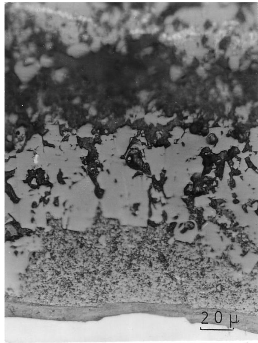
Bild 4. Chemisches reine Eisenscheibe (Mikroaufnahme) korrodiert in 0.1 n NiCl 2 . Auf Nickel ist grobkristalliner Magnetit angewachsen. Zwischen Eisen und porösen Magnetit ist ein hygroskopische Chloridphase vorhanden
