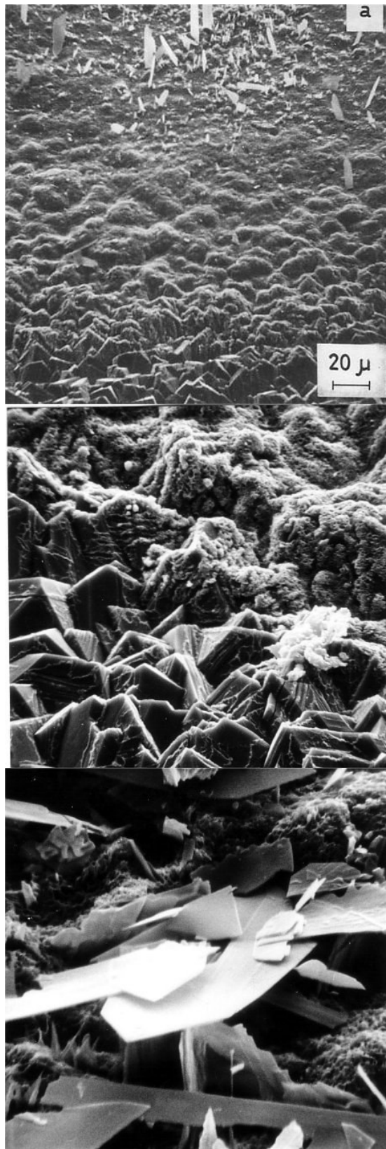
Afb. 14, 15 en 16 REM-beelden van een in oververhitte stoom geoxideerd ijzeren monster
