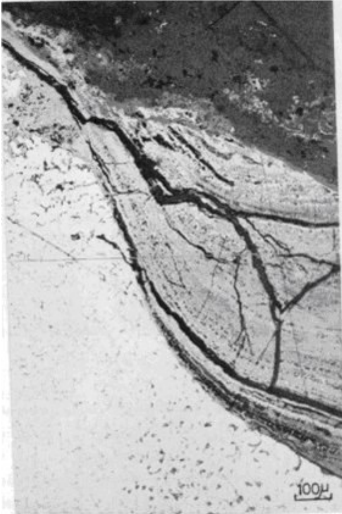
Figure 18: Microscopisch beeld van een dwarsdoorsnede uit de las van Figuur 17. Er is een sterk gelamineerde oxydelaag ontstaan onder de compact donkergrijze zoutlaag.
