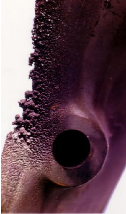
Figuur 1 Voorbeeld van druppelerosie aan een turbineschoep (foto KEMA)
