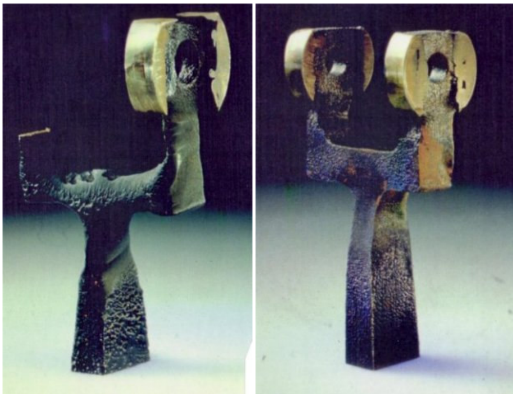
Figuur 21. Twee sterk door erosiecorrosie aangetaste schakelarmen van voedingwaterpompen (foto's KEMA).
